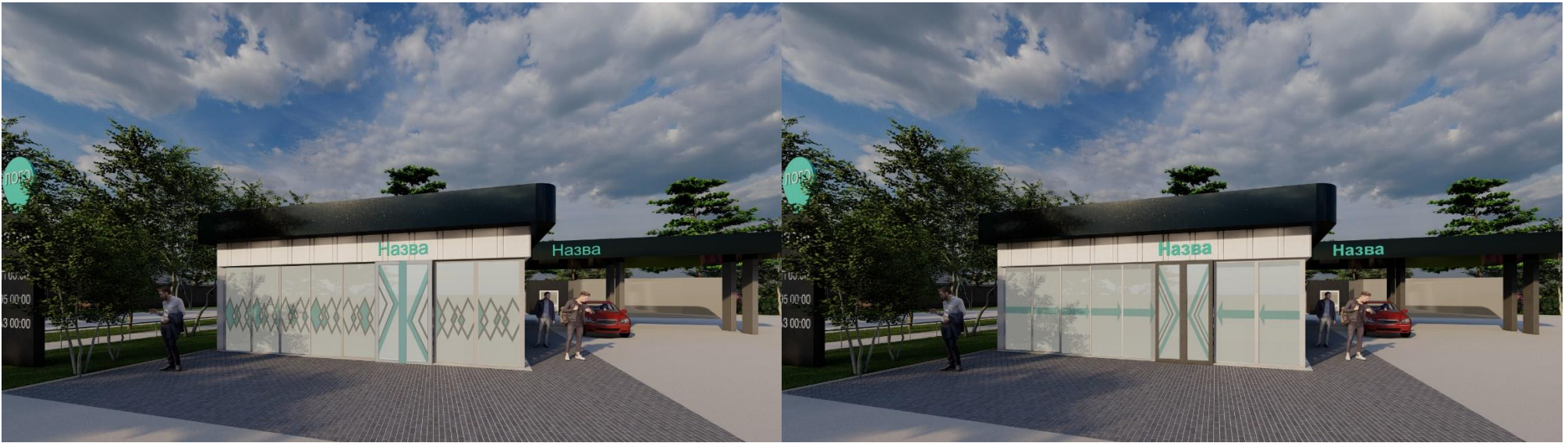
Рис. 31 Приклади контрастного маркування склопрозорих фасаду та дверей.
